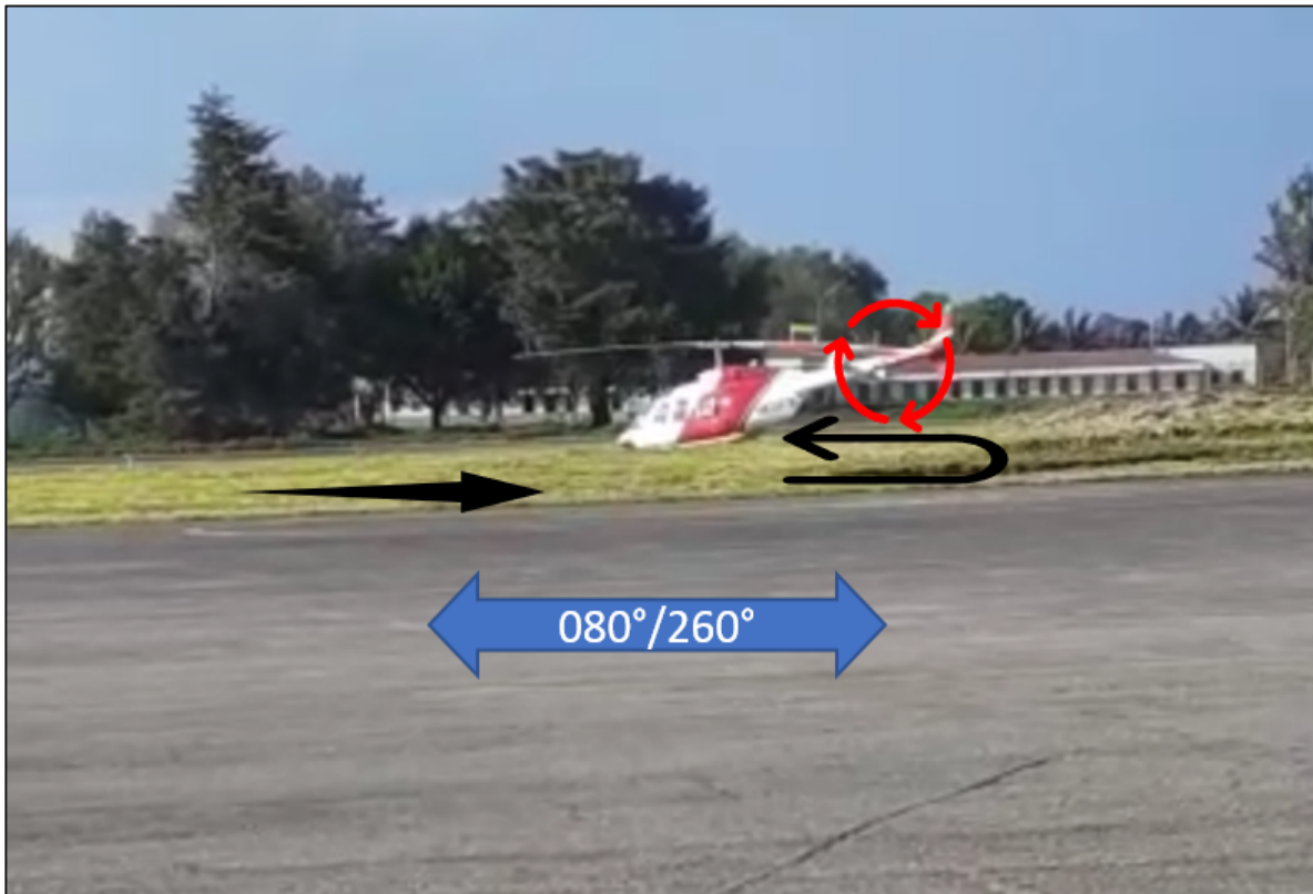
Fotografía No. 2 - Condición final helicóptero HK3978 y dirección de entrada al punto de aterrizaje
